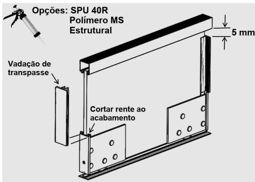
17 – Conforme figura acima, aplique uma das seguintes opções: SPU 40R; Polímero MS ou Estrutural no perfil de vedação de transpasse e cole-o no vidro, de maneira que fique bem alinhado e no prumo.
