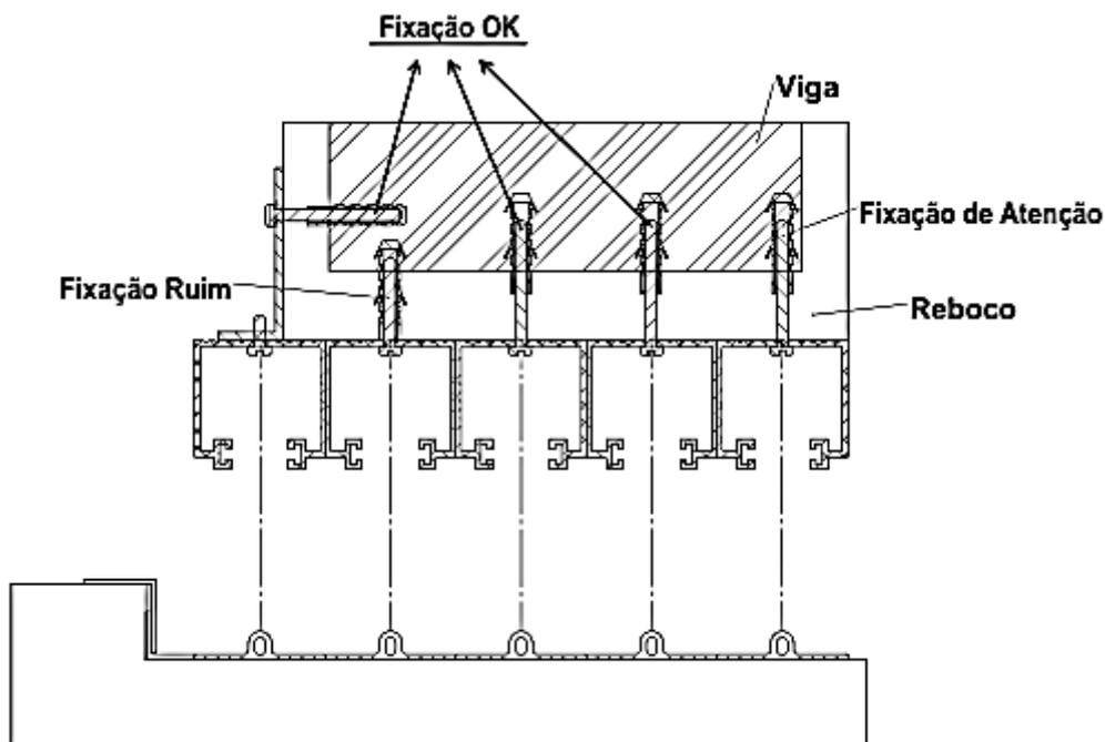
10 – A distância para fixação dos parafusos no trilho superior deve ser de 10 cm de cada extremidade (ponta do perfil) e 70 cm entre furos em toda extensão do trilho, ver figura abaixo. Utilizar bucha de 6 mm e parafuso de aço inoxidável. É importante inspecionar para que não tenha parafusos ressaltados, pois poderão provocar acidente no momento da colocação dos vidros.
