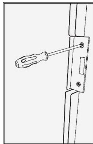
Fixe a testeira na alvenaria. Na sequência, monte a fechadura no vidro. Por fim, ajuste a fechadura com a testeira e aperte os parafusos.
